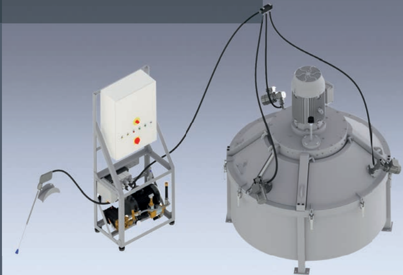
Pumpenaggregat mit Steuerung
